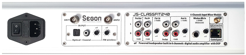
JS-CLASSFIT240 : Face arrière - connectique
